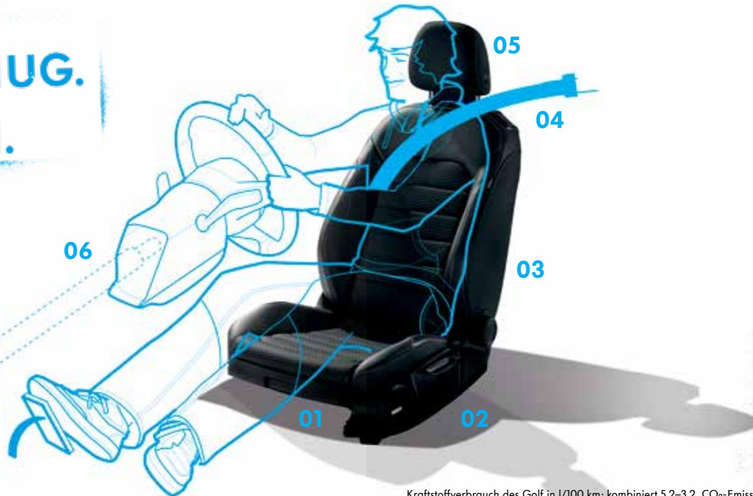
**05 Kopfstütze:** Dein Kopf und die Oberkante der Kopfstütze sollten sich auf gleicher Höhe befinden. Kopfstütze einfach ein Stück hochziehen oder mit dem kleinen Druckknopf an der linken Strebe absenken. **06 Lenksäule:** Schwenke den Hebel unter der Lenksäule nach unten, um das Lenkrad in Position zu bringen. Der Abstand zwischen dem Lenkrad und deinem Brustbein muss mindestens 25 Zentimeter betragen und du solltest alle Instrumente gut sehen können. Danach die Lenksäule wieder verriegeln.
